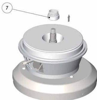
**Phase 2:** den drehbaren Teil der Gleitringdichtung herausnehmen (7), indem die Feder gegen den Uhrzeigersinn gedreht wird.
