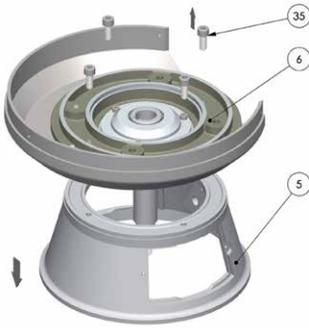
**E** - Von unten nach oben drehen, um an die Schrauben (35) zu gelangen, die die Trennung von Halterung (6) und Laterne (5) ermöglichen.
